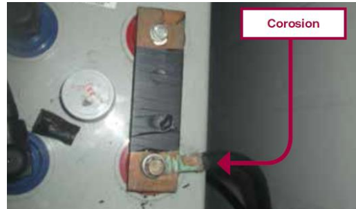
टर्मिनलमा खिया लागेको जसले गर्दा ब्याट्रीको इन्टर्नल रेजिस्टेन्स (Internal resistance) बढाउँछ ।
